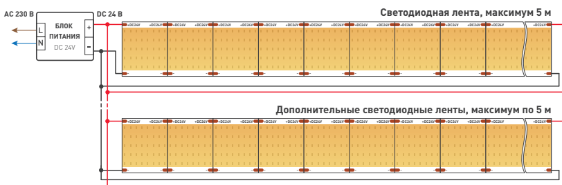
Схема 2. Подключение нескольких светодиодных лент с двух сторон
