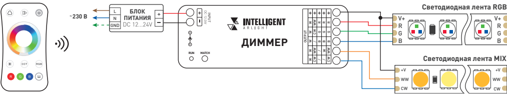
Рис. 1. Схема подключения диммера
