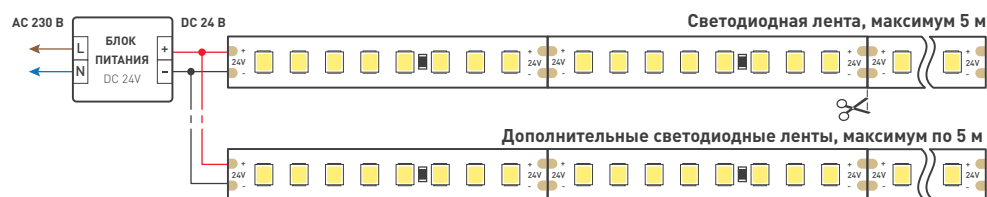
Рис. 1. Подключение нескольких светодиодных лент с одной стороны
