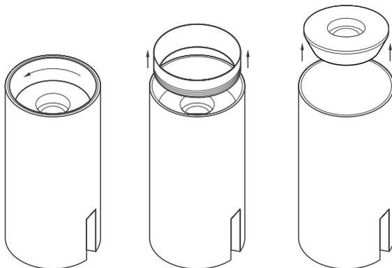
4. Установите в корпус светильника новую линзу. Обратите внимание на наличие специальных выступов-направляющих на линзе. Совместите выступы-направляющие с ответными отверстиями на креплении светодиода. Удерживая линзу, закрутите кольцо в корпус по часовой стрелке. Удобнее выполнять операцию, когда светильник обращен светодиодом вниз.
